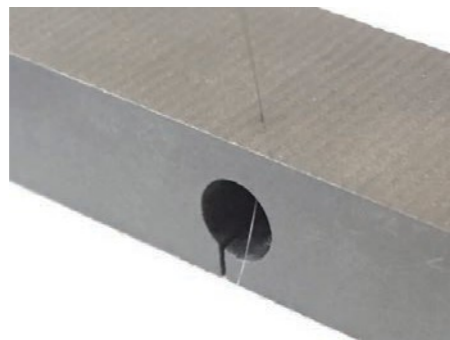
Werkstück Wolframcarbid Größe \varnothing 0.08 \times 2\text{mm}
