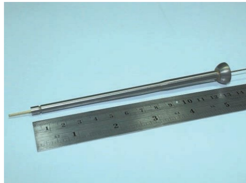
Werkstück Auswerferstift Stahl Größe \varnothing 1.2 \times 125\text{mm}
