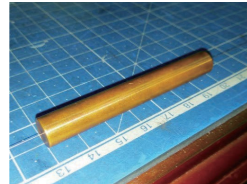
Werkstück OFHC, Reinkupfer Größe \varnothing 0.3 \times 67\text{mm}
