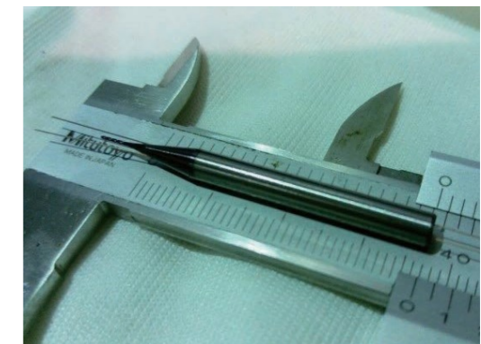
Werkstück Hartmetall Größe \phi 0.2 x 37mm
