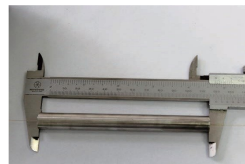
Werkstück SUS316 Größe \phi 0.3 x 120mm
