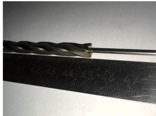
Werkstück Chirurgieinstrument Ti Größe \varnothing 2.5 \times 450\text{mm}
