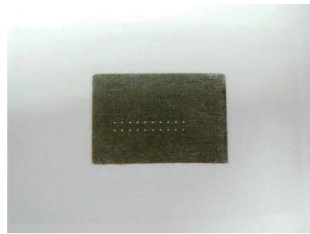
Werkstück SUS304 Größe \varnothing 0.05 \times 0.5\text{mm}
