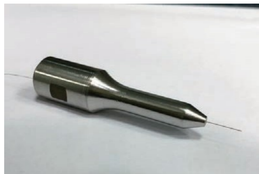
Werkstück Düse Größe \phi 0.2mm
