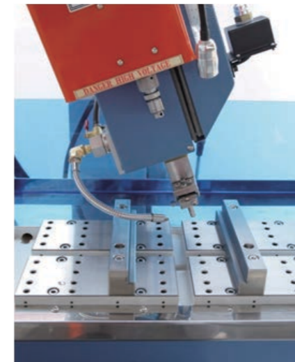
Schwenkbare B-Achse Hand oder Programmierbar
