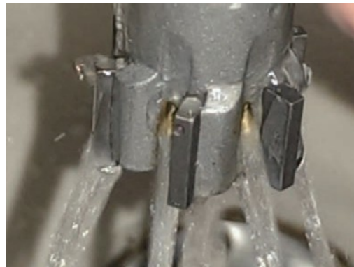
Werkstück Fräskopf Größe 6 - \phi 1.0mm
